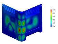
Con el software SolidWorks Simulation Premium para simular el rendimiento de los diseños, Macro Plastics puede utilizar la cantidad óptima de plástico para admitir las condiciones de carga concretas de cada producto, ahorrando de esta manera dinero y garantizando el rendimiento.
