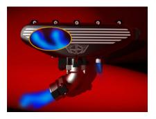
Donkervoort utilizó el software SolidWorks Flow Simulation para identificar y resolver problemas de acumulación de presión en los colectores de admisión del D8 GTO, con lo que mejoró el rendimiento del motor.
