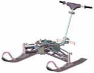
Figura 6: La suspensión frontal de una motonieve consta de muchos eslabones, como los resortes y los amortiguadores.
