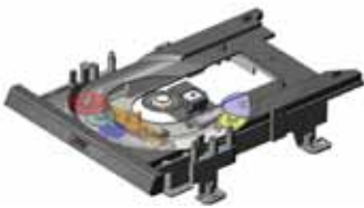
Figura 8: Una unidad de CD es un mecanismo complejo, pero fácil de analizar mediante la simulación del movimiento.
