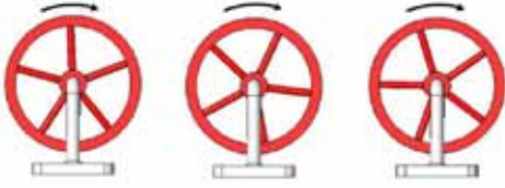
Figura 14: Un volante gira como un cuerpo rígido sobre la bisagra que lo une a la base (arriba). La presencia de movimiento de un cuerpo rígido (abajo) clasifica este dispositivo como un mecanismo.
