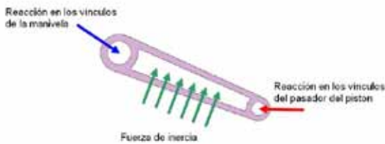
Figura 18: De acuerdo con el principio de d’Alambert, las reacciones en los vínculos están en equilibrio con las fuerzas de inercia.
