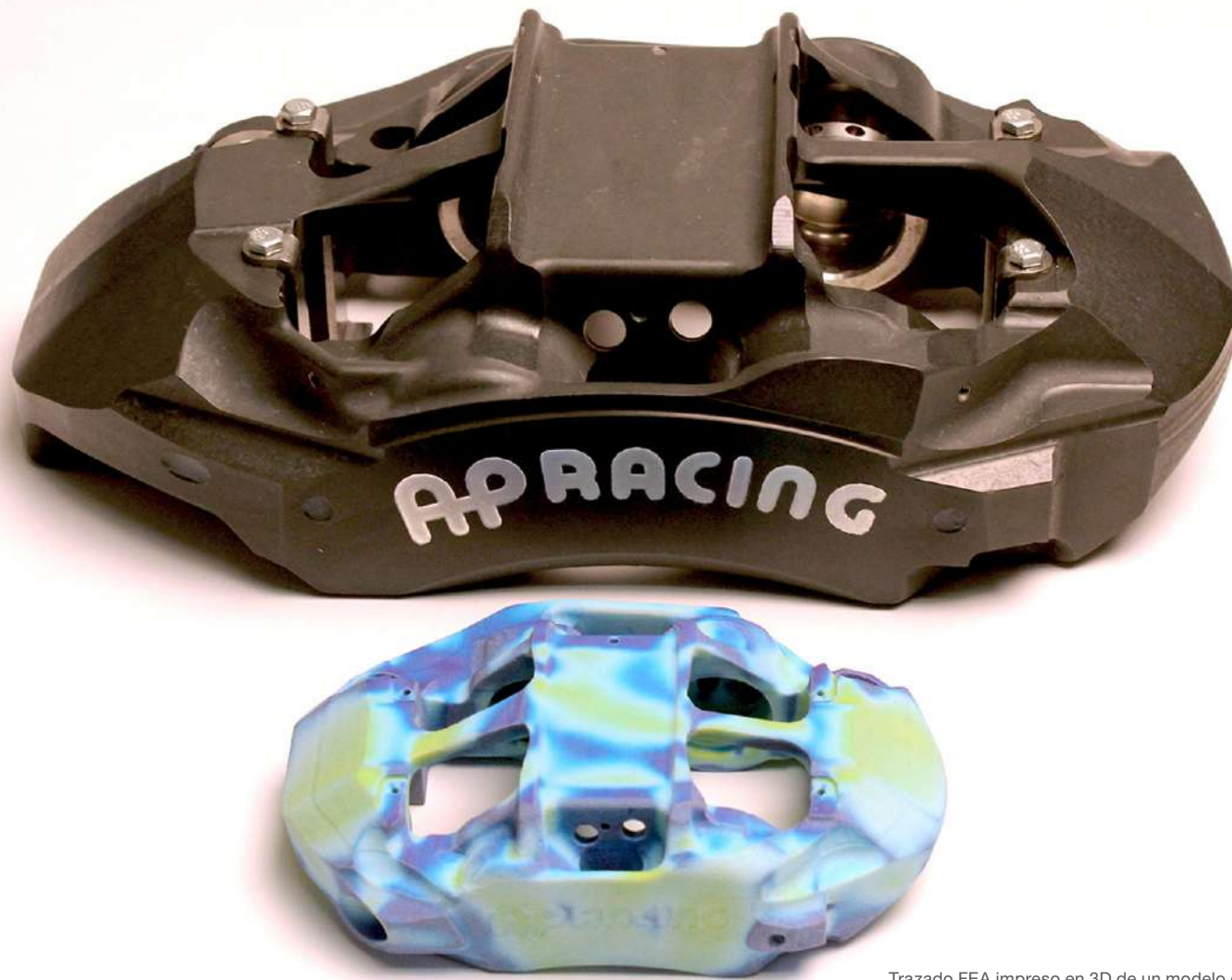
Trazado FEA impreso en 3D de un modelo de mordaza AP Racing
