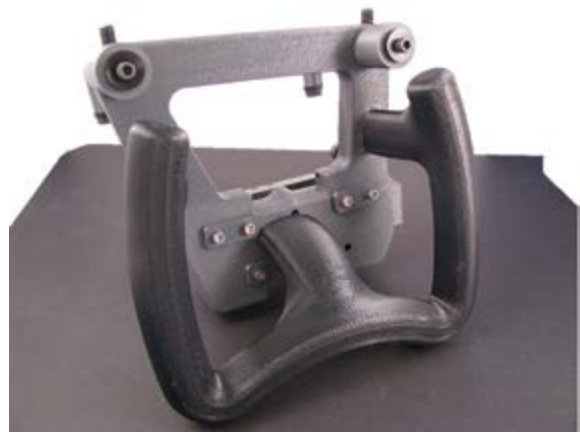
Esta herramienta de FDM rediseñada consolida la mayoría de los componentes.
