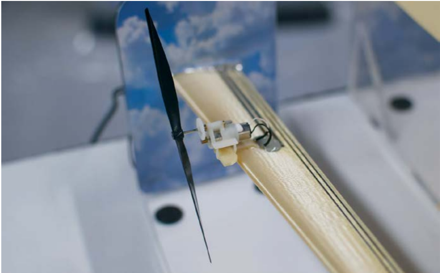
Aurora hizo esta ala enteramente de componentes impresos en 3D y electrónica impresa en 3D.
