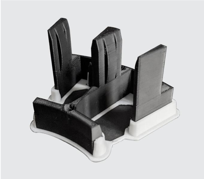
El filamento 3D Kimya ABS-EC (eléctricamente conductor) es una combinación de acrilonitrilo butadieno estireno y aditivos eléctricamente activos: nanotubos de carbono que le permiten conducir la electricidad. ABS-EC es resistente al impacto, al calor y al envejecimiento. Se utiliza en las industrias automotriz y electrónica.
