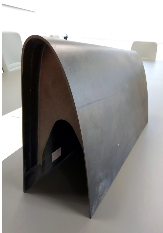
Pieza final en material composite de un ala de avión curvada producida con la tecnología FDM.
