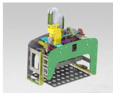
OYSTAR North America aprovecha las herramientas de SolidWorks Motion para realizar análisis de vinculación mecánica, que permiten a este fabricante posicionar con precisión los componentes, sin que colisionen o generen fuerzas no deseadas.
