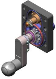
Con las herramientas de SolidWorks Simulation, TFT puede explorar innovaciones de productos de manera rentable, por ejemplo, mediante el uso de SolidWorks Motion para evaluar una innovadora transmisión por engranaje de tornillo sin fin epicicloidal para sus válvulas de gran tamaño.
