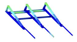
Con las herramientas de simulación de SolidWorks, SunEdison estudió los efectos de las cargas estructurales y debidas al viento, validando así el rendimiento del sistema de manera rápida y rentable.
