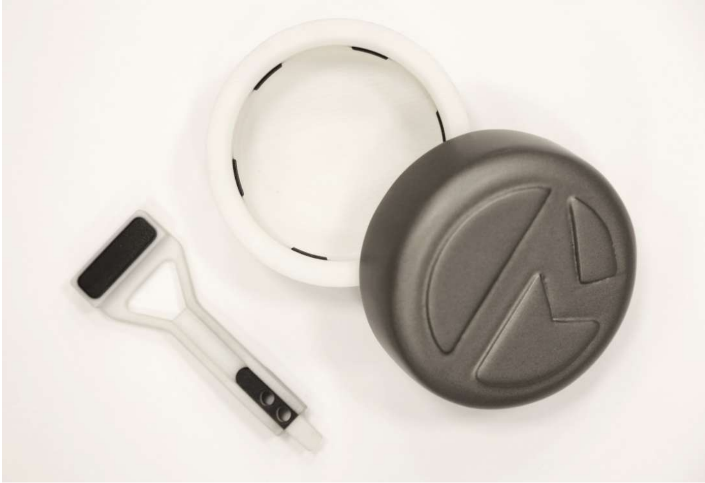
Pinza de sujeción (izquierda) y tapa de envasado (derecha); impresas en 3D con tecnología PolyJet de Stratasys. Se ha utilizado impresión 3D con múltiples materiales para crear los componentes estructurales blancos y las sujeciones similares a la goma de color negro en una sola impresión.
