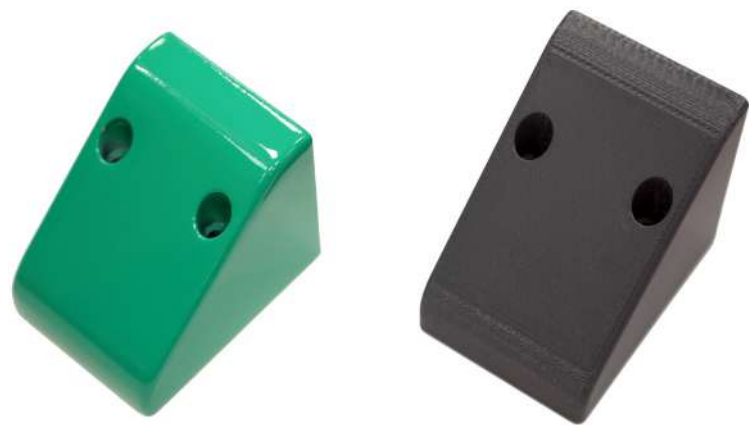
Carcasas protectoras impresas en 3D, resistentes y a la vez ligeras, utilizadas en máquinas de embalaje robótico. Fabricadas con la impresora Stratasys Fortus 450mc con material FDM Nylon 12CF y acabado de barniz verde.
