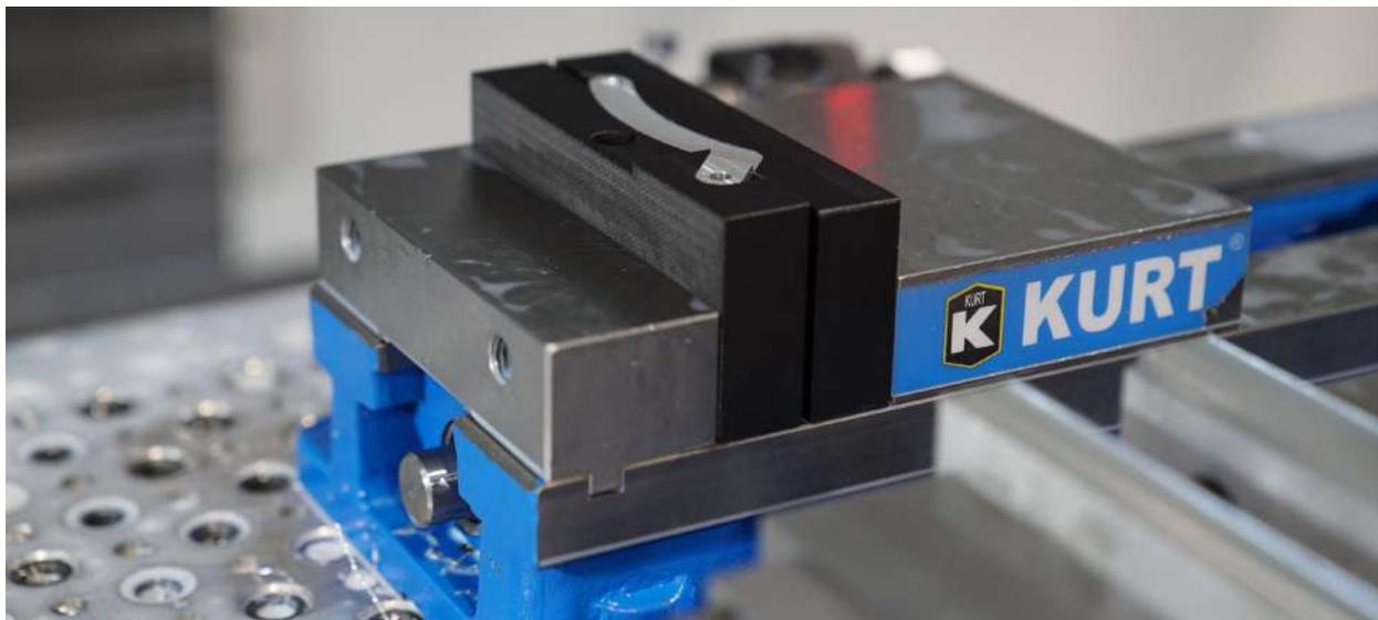
Las mordazas suaves hechas de fibra de carbono FDM Nylon 12CF alivian la carga de herramientas, lo que permite que las máquinas CNC produzcan piezas de valor agregado.
