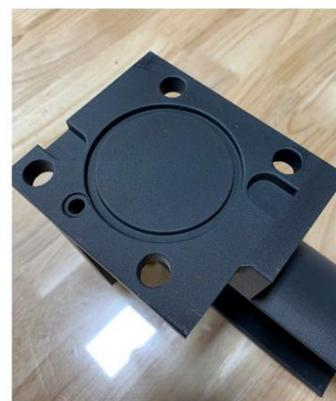
La brida de montaje del recogedor de piezas muestra el acabado superficial que se puede lograr con Material FDM Nylon-CF10.
